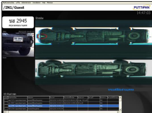
Auto Alert ตำแหน่งที่มีโอกาสเป็นวัตถุแปลกปลอมสูง
